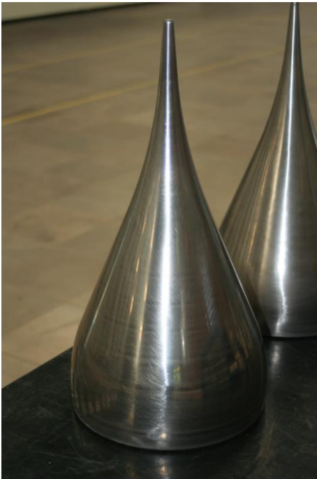
Agulha de Turbina Pelton com Carboneto de Tungstênio
